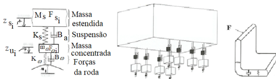
Fig. 1 - Suspensão para um veículo militar de oito rodas e modelo de assento para exemplo de cálculo por dualidade a partir do modelo elétrico na perspetiva de um engenheiro.
